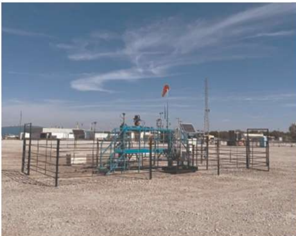
รูปที่ 4.8 บริเวณตำแหน่งของระบบท่อและหัวหลุมอัดฉีด CO 2 (ซ้าย) และบริเวณตำแหน่งของระบบท่อและห้องควบคุมระบบอัดฉีด CO 2 (ขวา) ของโครงการกักเก็บคาร์บอนของเครือบริษัท BKV Corporation ณ เมืองแดลลัส รัฐเท็กซัส สหรัฐอเมริกา
