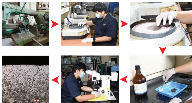
ขั้นตอนแนะนำในการตรวจสอบโครงสร้างจุลภาคในห้องปฏิบัติการ เพื่อวัดความลึกชั้นสูญเสียคาร์บอนที่ผิว
