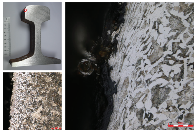
พบชั้นสูญเสียคาร์บอนที่ผิว การเสียรูปร่างอย่างรุนแรง และรอยร้าวจากการล้าแบบกลิ้งสัมผัสในรางใหม่ที่เพิ่งเริ่มใช้งาน
