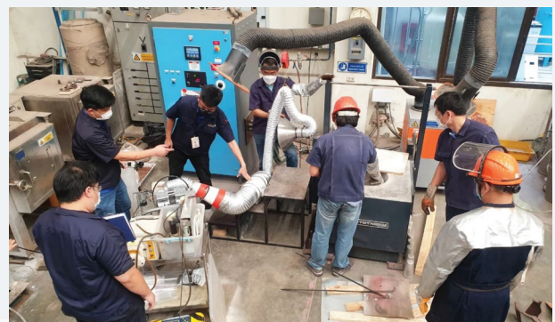
การทดลองหลอมเศษอะลูมิเนียมประเภทพ่นสีฝุ่น และเก็บแก๊สในระดับห้องปฏิบัติการ
