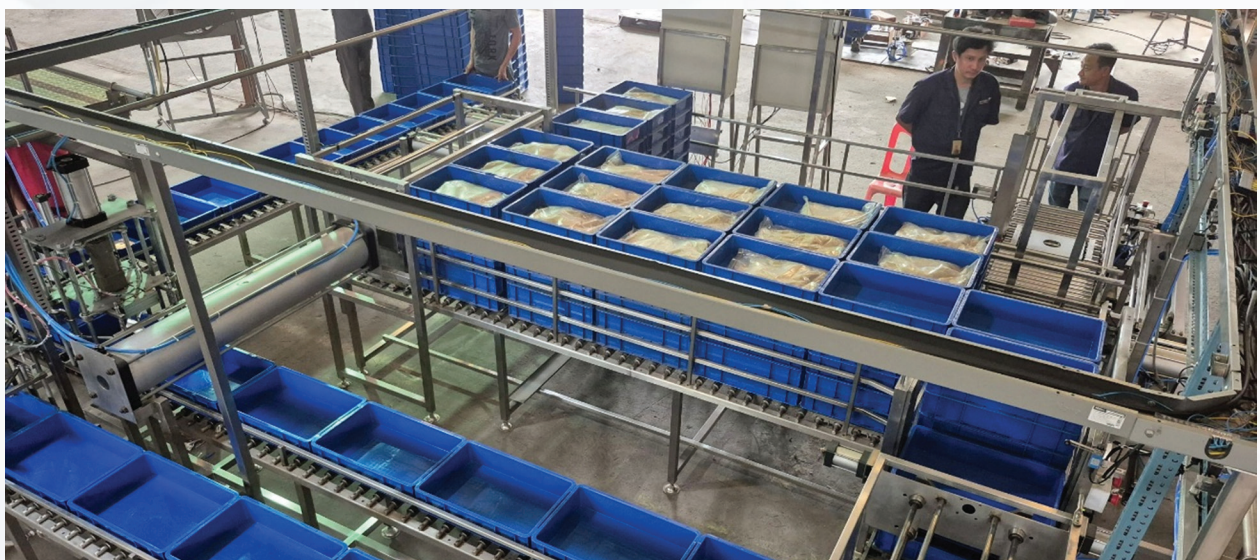
เครื่องผลิตแผ่นยางจับตัวแบบต่อเนื่องด้วยระบบกึ่งอัตโนมัติ
