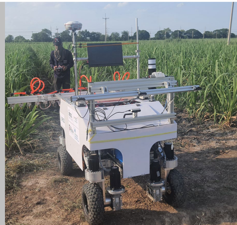
Terra: แพลตฟอร์มหุ่นยนต์เคลื่อนที่อัตโนมัติทางการเกษตรสำหรับการควบคุมวัชพืชในไร่อ้อย
