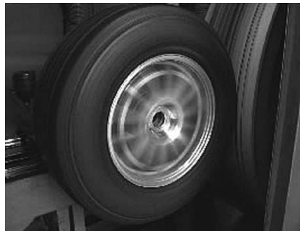
ภาพที่ 7 การทดสอบจริงบนเครื่องทดสอบความล้า ตามแนวรัศมีในเชิงพลวัต
