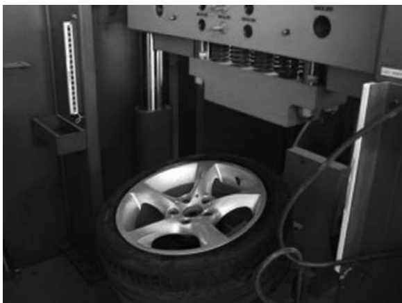
ภาพที่ 9 การทดสอบจริงบนเครื่องทดสอบการกระแทก ภาพจาก http://www.leggera.eu/en/information/info-43.html
