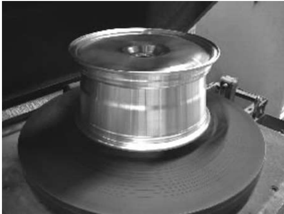
ภาพที่ 5 การทดสอบจริงบนเครื่องทดสอบ ความล้าตามมุมในเชิงพลวัต
